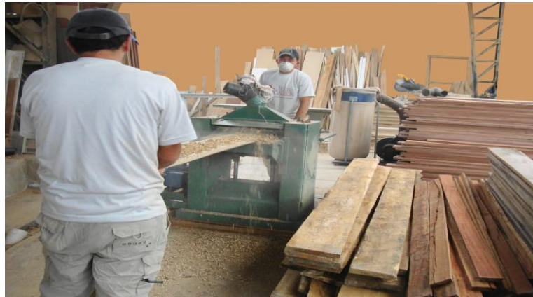
Fotografía 6 : Cepillado de la Madera
