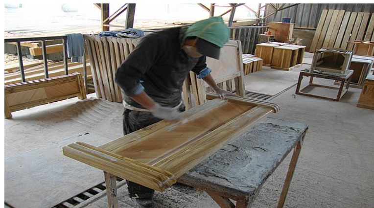
Fotografía 9 : Lijado y Masillado
